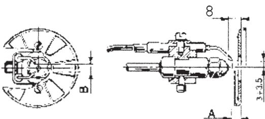
Die Elektroden sind werkseitig eingestellt. Die angegebenen Maße dienen zur Kontrolle.
